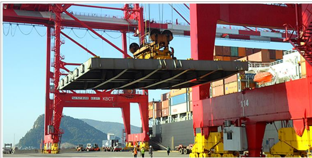
Figure 5. Mouvement de couverture de trappe navire-quai
