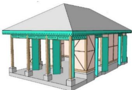
Toiture à 4 pans
