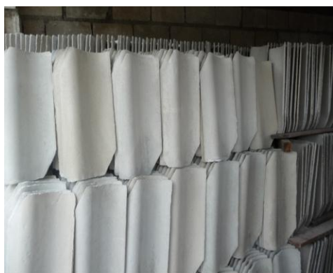
Figure 6.4.11.7- 1_Tuiles en mortier vibré de ciment (« tuiles micro-béton ») produites en Haïti, photos
