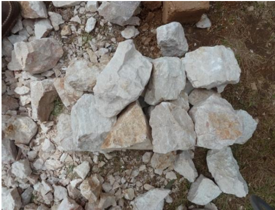
Figure 6.4.3- 1_identification des types de pierres appropriées pour la construction
