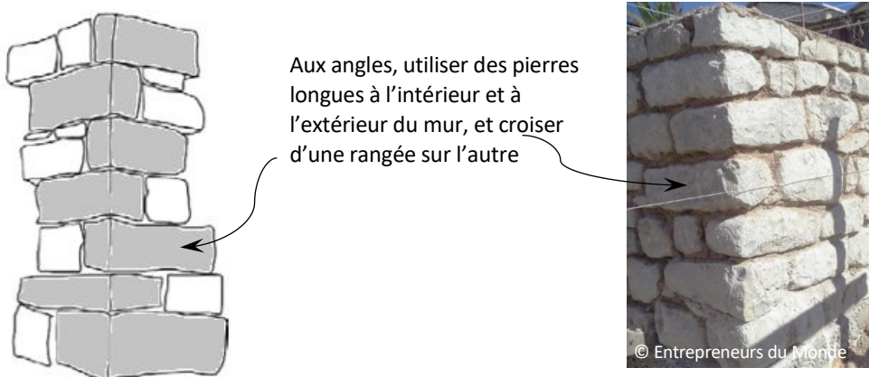
Figure 6.4.3- 3_Appareillage des angles : schéma 3D et photo de mise en œuvre
