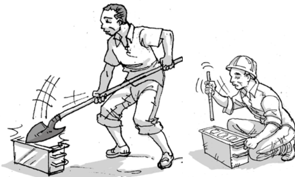
4. Tasser et vibrer le mélange dans le moule
