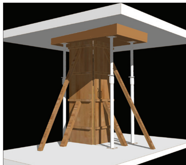
7. Placer le coffrage
