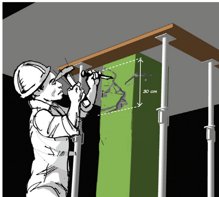
2. Retirer avec précaution le béton endommagé autour des armatures sur une longueur ne dépassant pas 30 cm [12 pouces].
