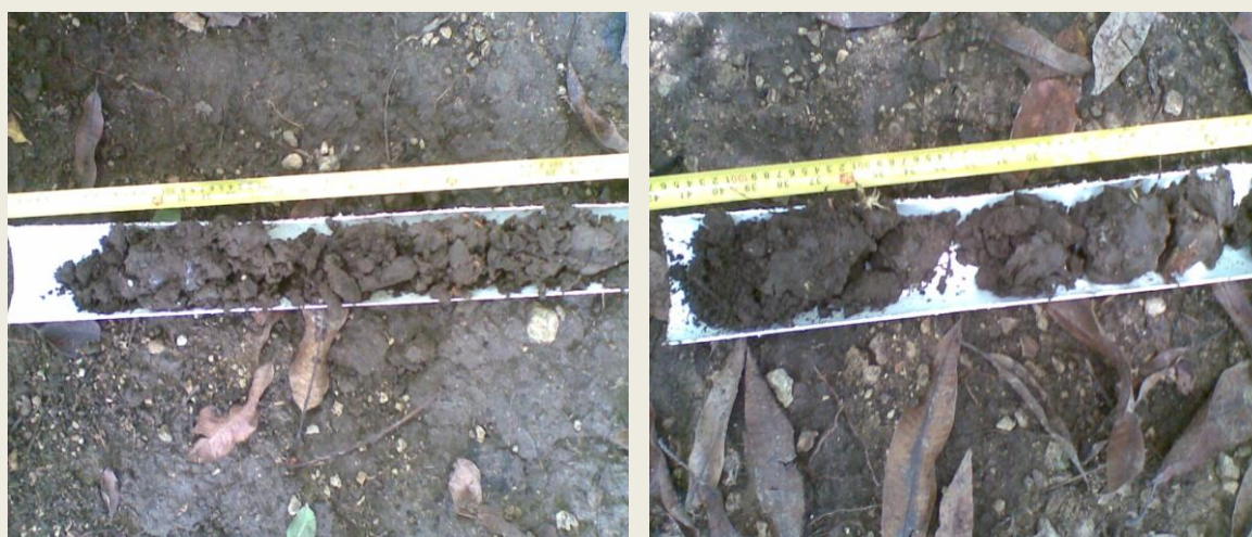
Figure 11. Profil de sol compacté (teneur en argile > 45%)
