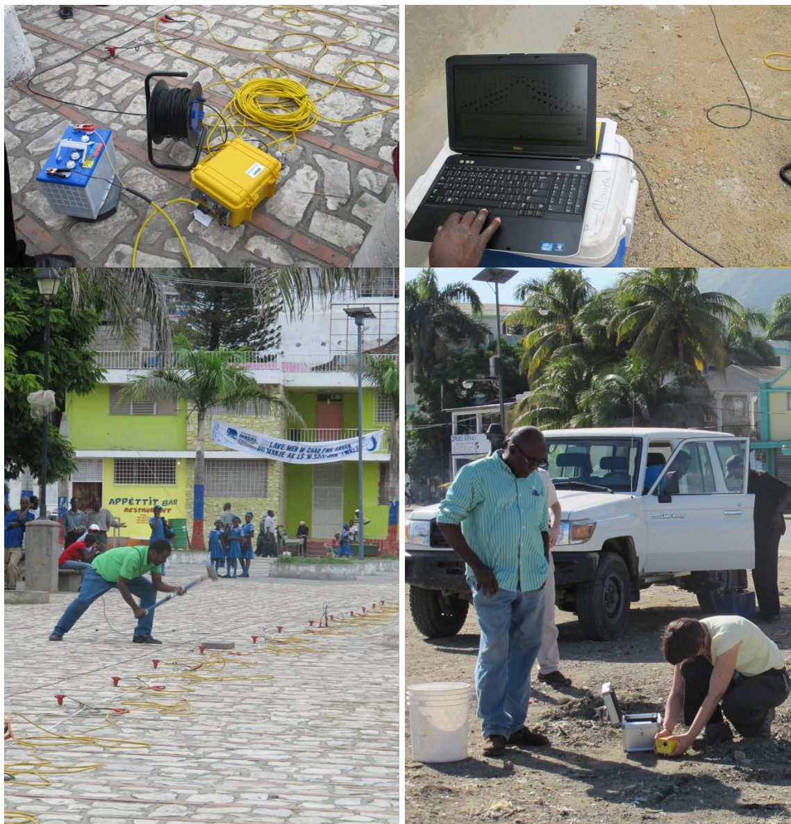
Figure 7 : Matériel acquis sur projet : en haut coffret d'acquisition MASW Geode et PC d'acquisition avec logiciel SeiSimage. En bas à gauche, flute de capteurs MASW ; en bas à droite, appareil de mesure H/V Tromino et en arrière plan un des véhicules du projet.
