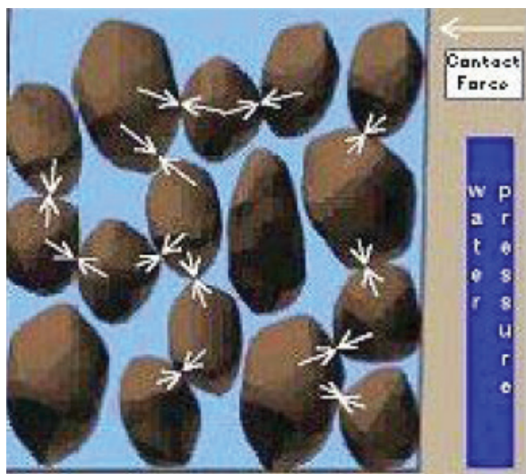
Sol à l'état initial - Représentation des forces de contact entre les grains
