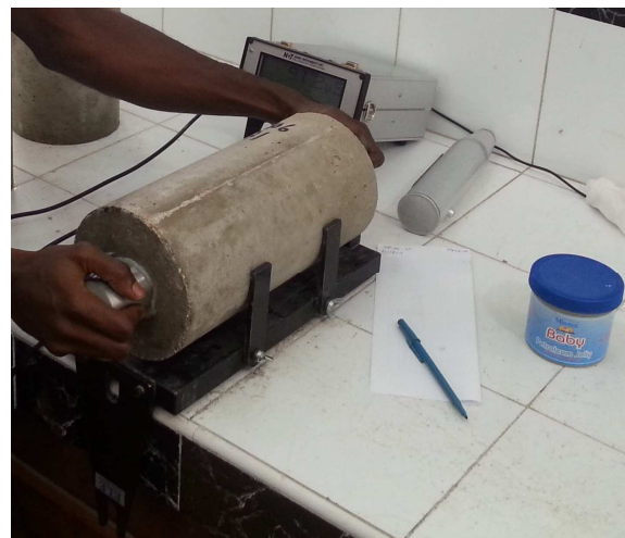
Figure 5. Dispositif ultrasonique avec mesure longitudinale
