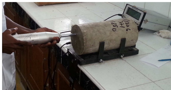
Figure 6. Mesure des indices sclérométriques sur les éprouvettes cylindriques
