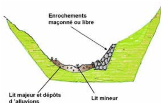
La stabilisation de berge en enrochements : parade contre les glissements de petite à moyenne ampleur
