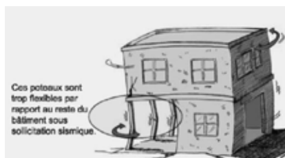
3 – Contreventements dissymétriques et rez-de-chaussée ouverts d'un côté
