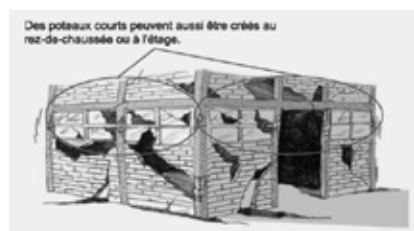
6 – Cadres partiellement remplis créant des poteaux courts
