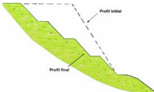
Le reprofilage des versants : une parade contre les glissements de moyenne ampleur
